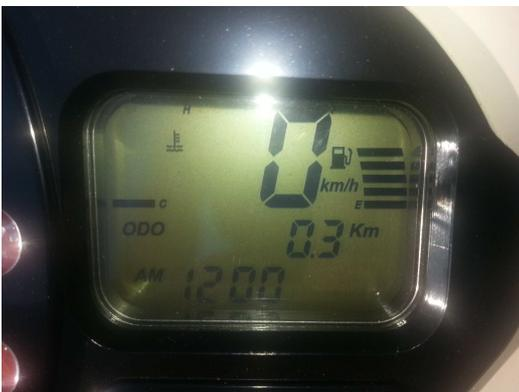
Zeigt den Stand des Kraftstoffes bei eingeschalteter Zündung oder laufendem Motor.
