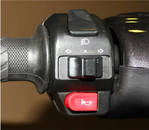
In dieser Stellung ist das Fernlicht aus. Wenn Sie den oberen Schalter nach vorne betätigen leuchtet das Fernlicht.
