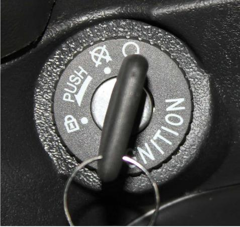
LOCK Zündschloss ist abgeschlossen, indem Sie den Lenker nach links drehen und den Schlüssel auf LOCK drehen Sie können den Schlüssel entfernen. Die Lenkersperre ist aktiviert. Die Stromzufuhr wird unterbrochen.
