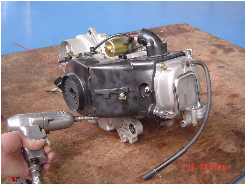
Fig. 17. Install fan cover, wires etc.
