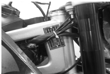
Ajoneuvon valmistenumero (VIN) löytyy rungon etuosasta oikealta.
