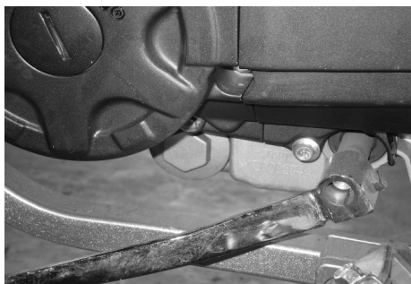
Moottorin valmistenumero löytyy oikealta moottorin alareunasta.
